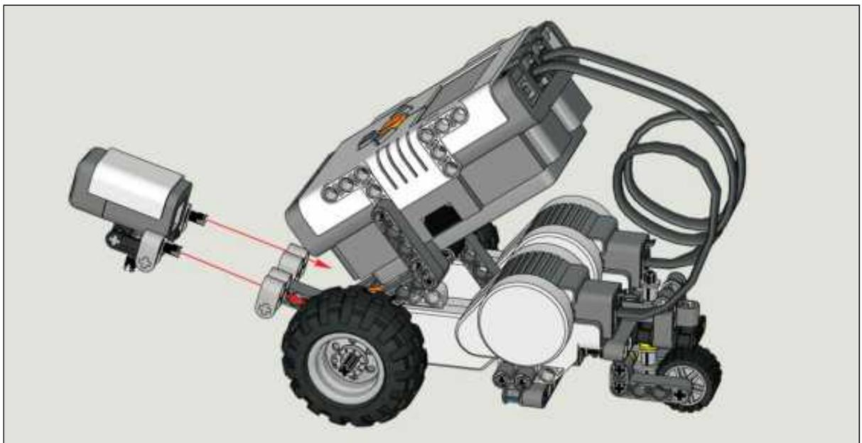
Закрепите датчик на базовом шасси так, чтобы он смотрел вперед.
