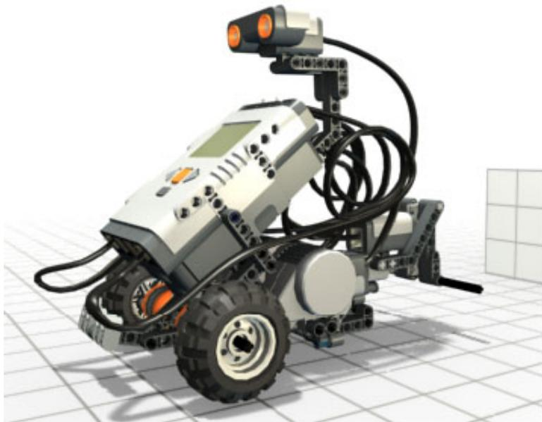
Теперь наш робот снабжен двумя датчиками: смотрящим вперед ультразвуковым дальномером и задним бампером с датчиком касания. Робот должен определять препятствия как впереди, так и позади себя.
